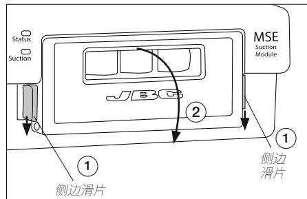
向上拉动 (3) 过滤器，使过滤器与密封件的卡扣脱离即可将其取出。
