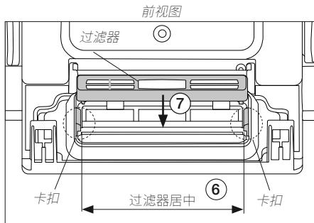
过滤器在卡扣之间放平后，将其向后推 (8)，直到抵住透明棱条。
