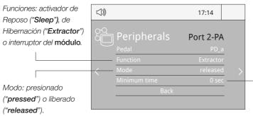
Ajuste la duración mínima de activación del pedal. Para un funcionamiento continuo, mantenga pisado el pedal\*.
