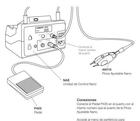
seleccionar el modo de activación del pedal y elija entre "Presionado" y "Liberado".
