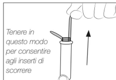
Per rimuovere gli inserti, tenere l'impugnatura ed estrarre gli inserti. Se necessario, utilizzare delle pinze.
